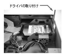
4. 電源ケーブル、信号通信ケーブル (IDEケーブル)、ファンケーブルを抜き、次はHDDブラケットを 製品の中央に向かって引っ張って底に固定された部分を外し、本製品からHDDブラケットを取り外 します。
